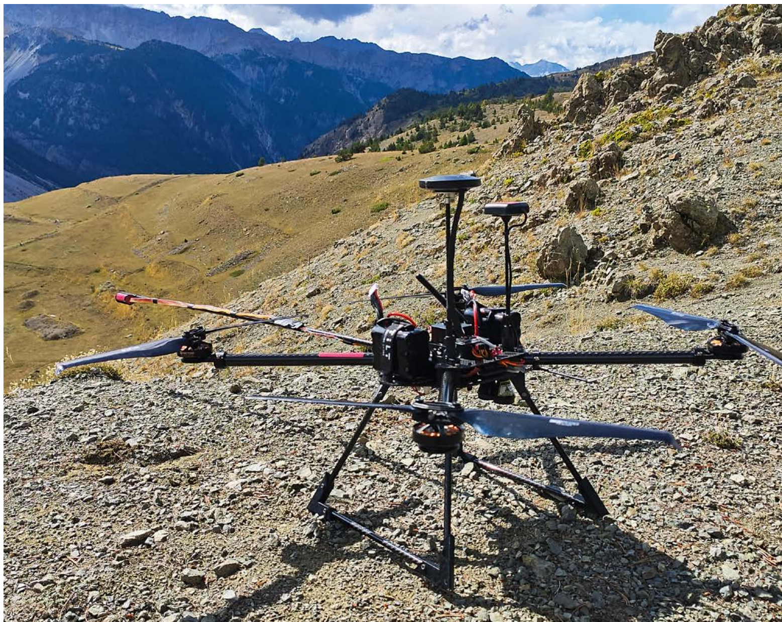
Magdrone : une innovation pour corriger les données de mesures magnétiques terrestres grâce à un drone.
