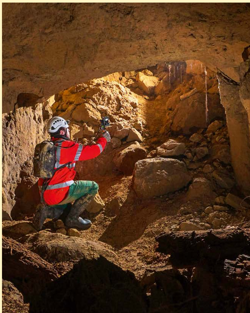
Les spécialistes des risques cavités explorent les cavités souterraines pour y déceler les signes d'instabilité en s'appuyant sur les dernières avancées en matière de numérisation 3D (Haut-Rhin).
