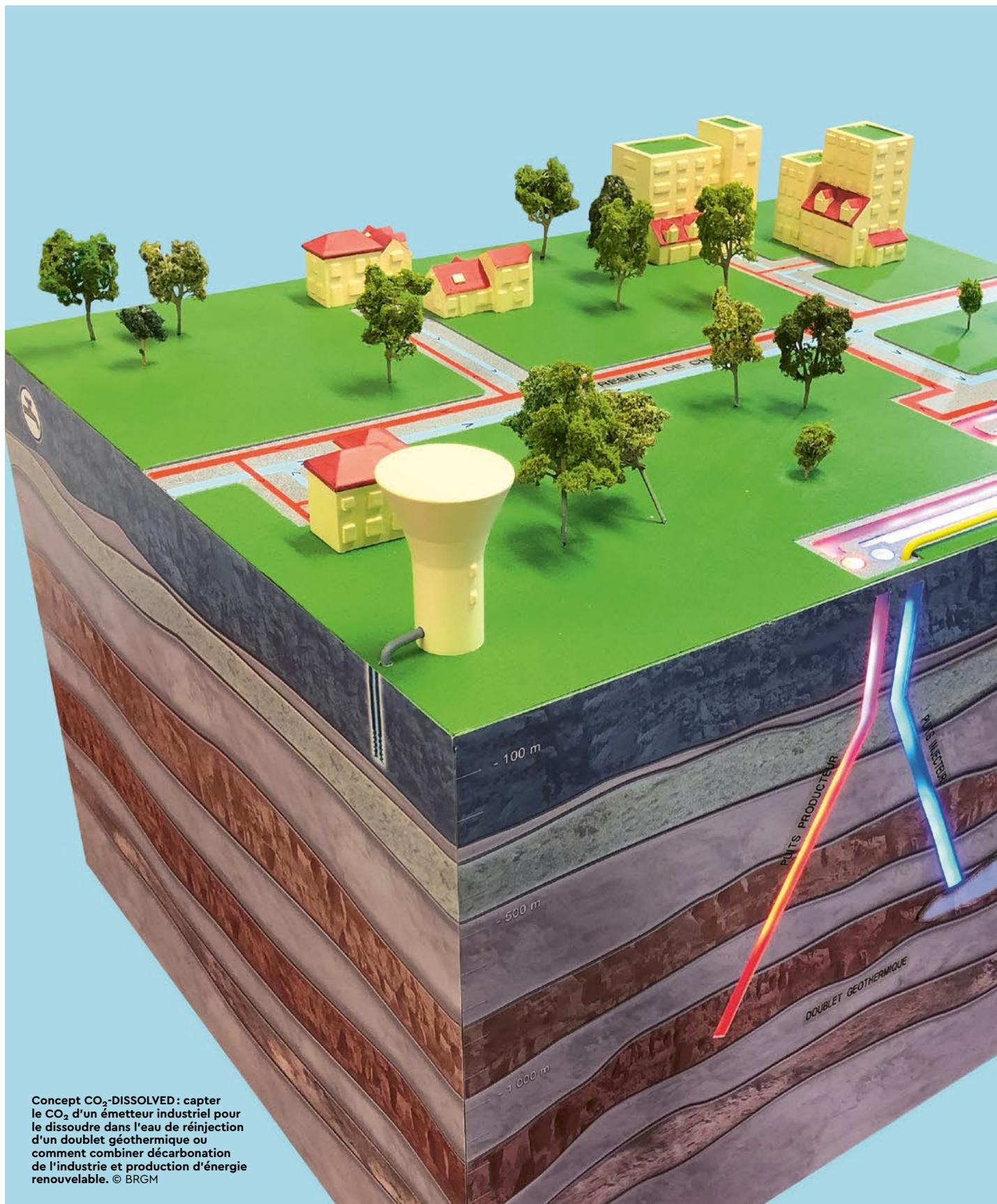
Concept CO<sub>2</sub>-DISSOLVED : capter le CO<sub>2</sub> d'un émetteur industriel pour le dissoudre dans l'eau de réinjection d'un doublet géothermique ou comment combiner décarbonation de l'industrie et production d'énergie renouvelable. © BRGM
