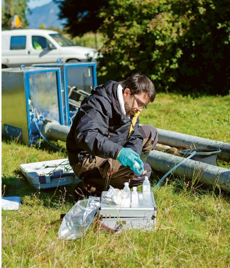
Prélèvement d'eau effectué dans un objectif de diagnostic de qualité et de recherche de potentiels polluants, à Pontcharra (Isère).
