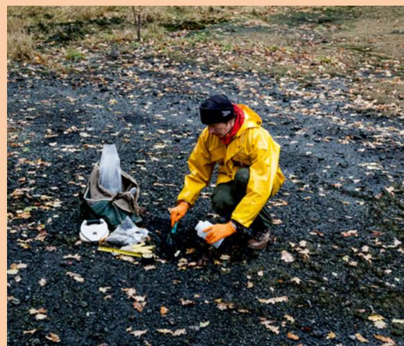
Échantillonnage de résidus de brûlage de munitions chimiques ex-allemandes sur le site dit « la place à gaz » dans la forêt de Spincourt, dans le département de la Meuse.
