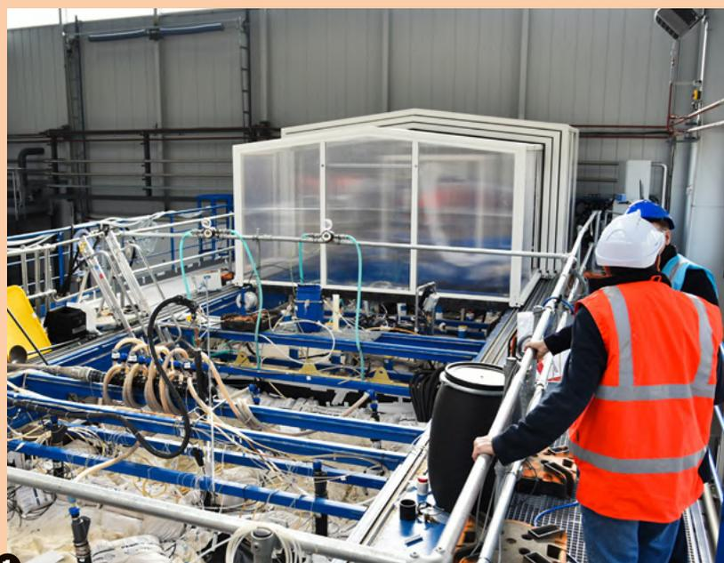
**Image 1** — L'installation d'un pilote de 80 m<sup>3</sup> sur la plateforme PRIME a permis de décrire l'infiltration dans le sous-sol des PFAS contenus dans des mousses anti-incendie. © BRGM
