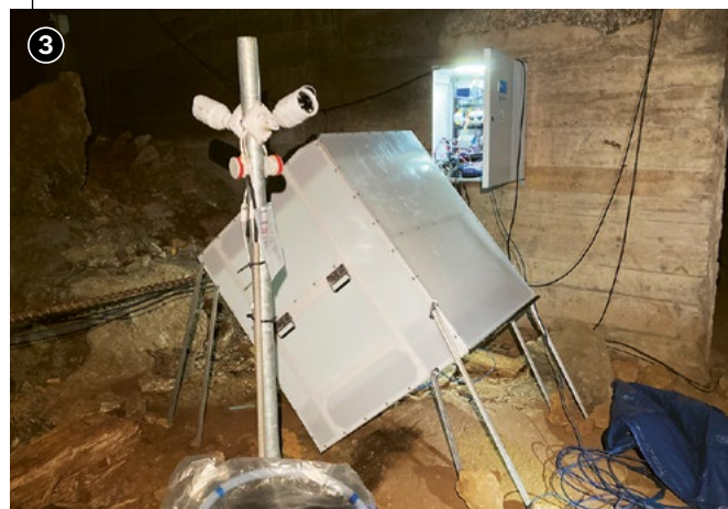
Télescope à muons installé dans une ancienne mine de fer à Thil. © BRGM
